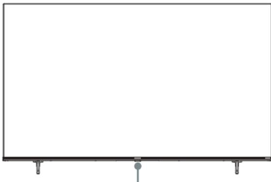
Fernbedienungssensor / Betriebsanzeige / Multifunktionstaste (Standby / Quelle)
